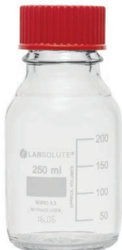
Avec des bagues de déversement rouges et des bouchons à vis en PBT avec un joint silicone supplémentaire recouvert de PTFE. Le joint empêche les substances hautement volatiles de se diffuser à travers le couvercle. Stérilisable à l'air chaud à 180 °C.
