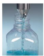
Pour vider l'échantillon, il suffit d'ouvrir la vanne en l'appuyant sur le récipient collecteur
