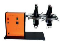
Agitateur pour mesurer la charge totale en oxygène de la bière conditionnée.
