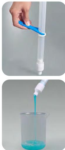
ViscoSampler, doté d'une forte puissance d'aspiration pour les fluides de forte viscosité. Le piston aspire le fluide, avant de l'expulser ensuite. En PTFE/FEP ultra-pur et chimiquement inerte pour collecter des échantillons sans contamination. Conçu spécialement pour les substances visqueuses telles que les boues, la vase, les échantillons de sols et d'argile, les sédiments, les huiles, les émulsions, les crèmes etc.
