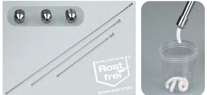
Préleveur pour substances visqueuses telles que pâtes, boues, crèmes, huiles. Le piston permet d'aspirer l'échantillon et de l'expulser directement dans un récipient collecteur. Nettoyage facile pour un prélèvement irrécusable. Selon le degré de viscosité, la pointe d'aspiration dévissable peut être livrée avec un perçage de 2 à 6 mm.
