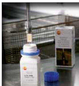
Flacon d'huile pour étalonnage / ajustement du testeur d'huile
