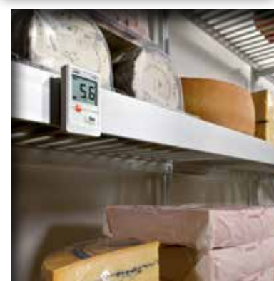
Enregistrement de la température et de l'humidité en ambiance du produit
