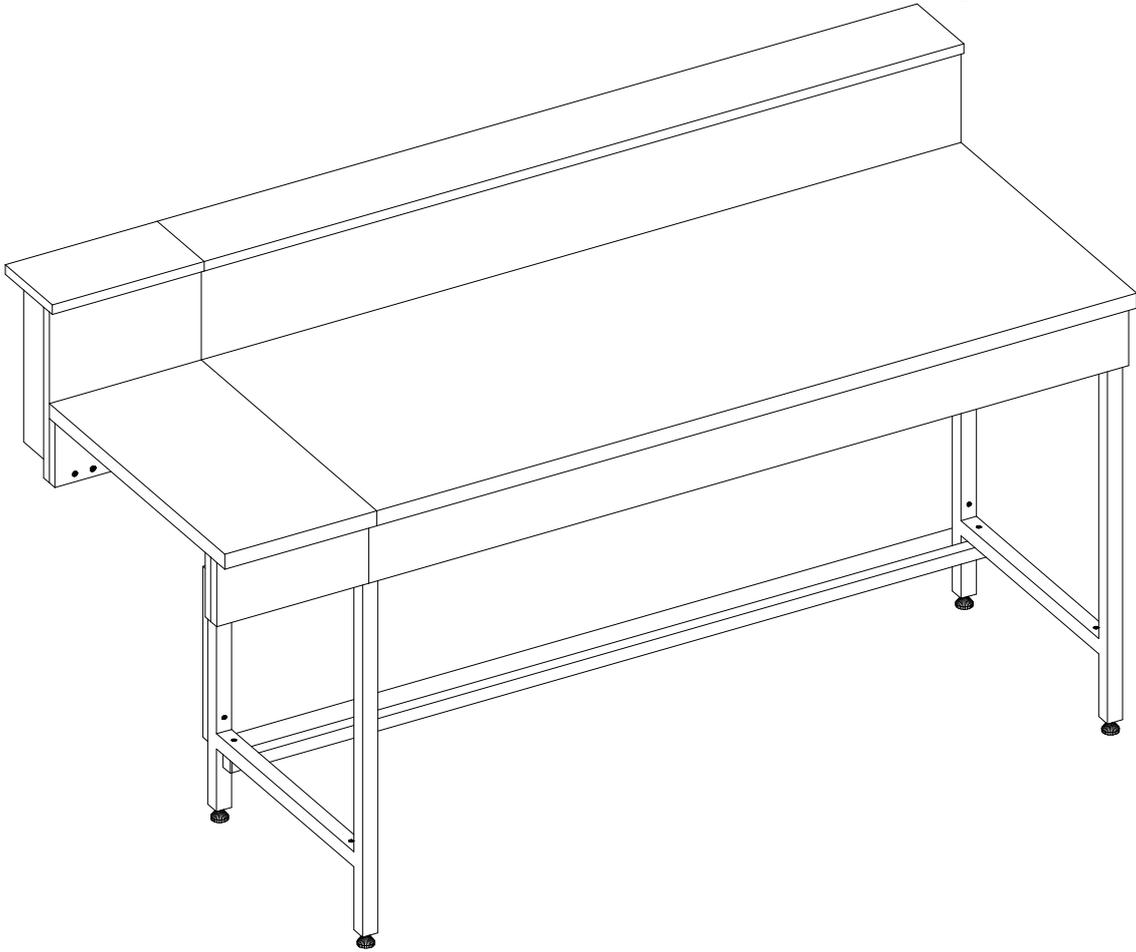
PS : Fixation du plan de travail avec des vis TF 4\*35
