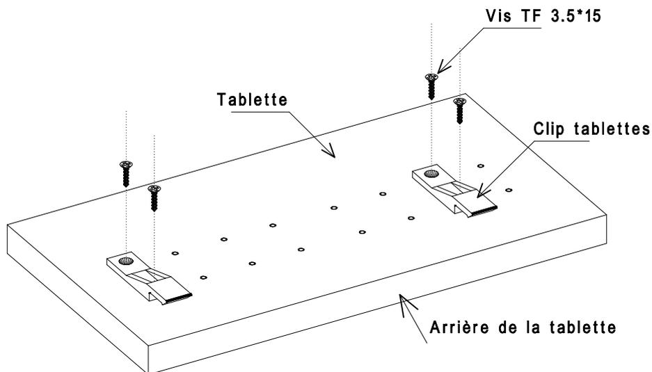
PS : Mettre en place les clips sur la tablette par rapport à la position des support tablettes sur le dossierer
