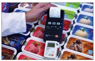
Pouvoir imprimer les données sur site à grande vitesse! Testo a concrétisé cette demande avec l'imprimante rapide testo 575, qui maintenant peut aussi reconfigurer l'enregistreur, sans avoir à raccorder un PC.
