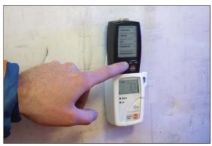
Collecter les données sur site, les lire et les exploiter de manière centralisée sur le PC. Aucun problème avec le testo 580, le collecteur de données, petit et performant, au format de poche.
