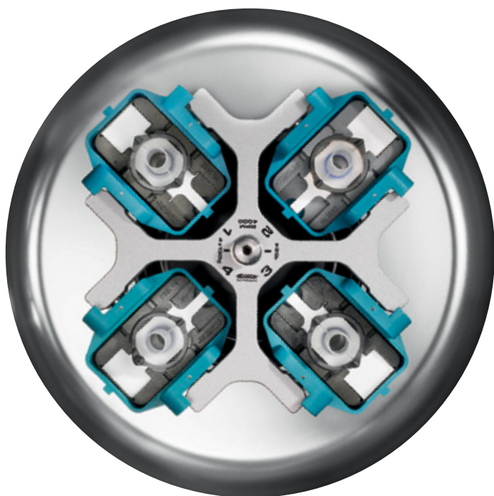
Un coup d'œil dans la cuve pour découvrir le rotor 1624 avec des nacelles 1660 pour chambres cytologiques
