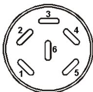
Figure 21: Affectation des pins de la douille DIN
