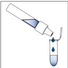
3. Transférer 12 gouttes (400 µl) de surnageant d'échantillon dans le tube d'incubation en pressant le tube d'extraction.
