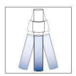
2. Reboucher le tube avec le bouchon, et agiter vigoureusement manuellement pendant 1 minute. Retirer le bouchon du tube d'extraction et le remplacer par le bouchon compte-goutte.
