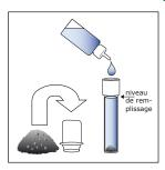
1. Homogénéiser l'échantillon, en peser 0,2 g et les déposer dans le tube d'extraction (si aucune balance n'est disponible, le poids peut être estimé en remplissant le bouchon du tube). Remplir le tube avec la solution d'extraction jusqu'au niveau indiqué sur le schéma.
