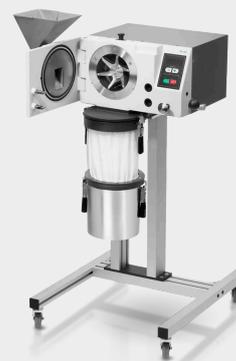
Le broyeur à percussion SR 300 convient pour le **concassage et le broyage fin** par **lots ou en continu**. Ce broyeur broie des **substances organiques et inorganiques sèches, tendres et mi-dures**.
