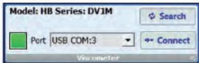
Le viscosimètre DV1 communique avec un PC via le port USB A. Le câble de liaison est fourni avec le logiciel Wingather SQ. Le bon fonctionnement de la communication est indiqué par un voyant vert à côté du port correspondant.
