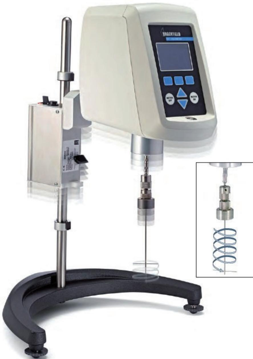
Conçu pour mesurer la viscosité et la consistance de gels, pâtes, crèmes, mastics, gélatine et autres produits à faible écoulement.
