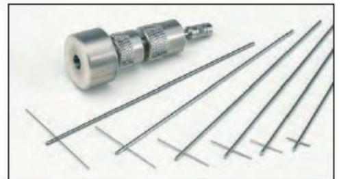
Le support Helipath est compatible avec tous les viscosimètres Brookfield standard ; il est livré complet avec un jeu de 6 mobiles en T et un raccord spécial.
