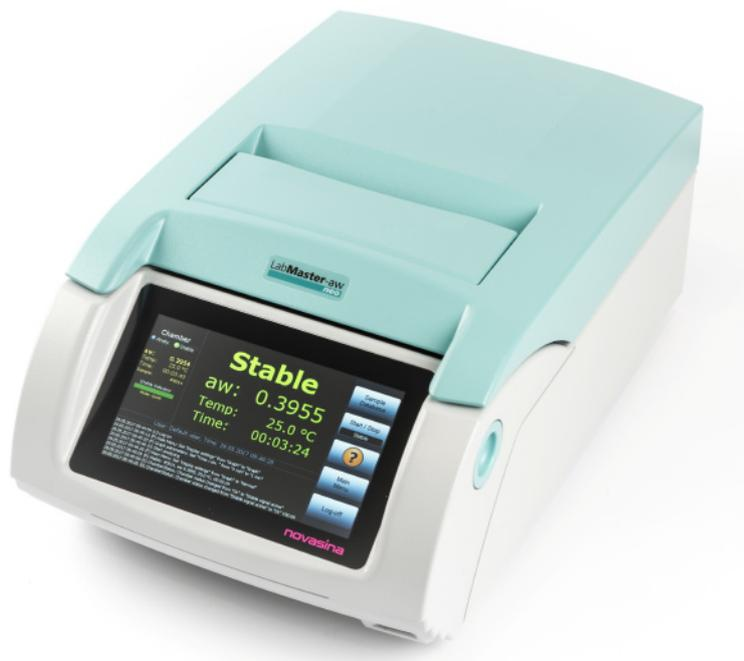
Le **LabMaster-aw neo** est équipé d'un système de reconnaissance automatique des sels étalons par RFID. Il intègre une carte SD utilisée pour stocker les données de programmation et les mesures. Ces données peuvent être lues sur un PC ou avec le logiciel Novalog MC. Le Logiciel de chaque **LabMaster-aw neo** peut être actualisé en utilisant cette carte SD qui accepte les nouvelles versions de programme. De cette manière, l'instrument peut être remis à jour à tout moment.
