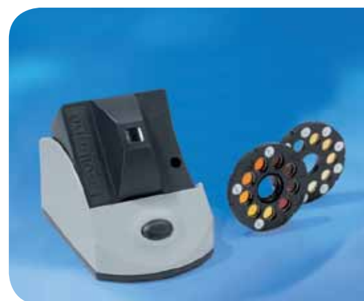
Eclairage à lumière naturelle avec comparateur et disques, alimentation sur secteur
