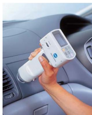
La sonde de mesure peut être utilisée indépendamment du calculateur. Ceci présente l'avantage de pouvoir la transporter et de l'utiliser dans des espaces réduits.
