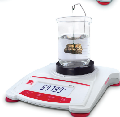
Scout illustrée avec le kit de détermination de densité en option
