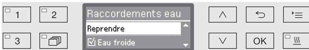
Le réglage des raccords à l'eau doit faire l'objet d'une sélection multiple. A l'écran, chaque raccordement à l'eau est suivi d'un petit carré  qui apparaît coché  en cas d'activation du raccordement correspondant. Il est possible d'activer ou de désactiver tous les raccords à l'eau.
