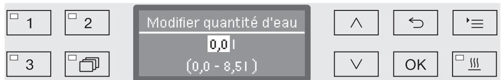
On peut soit augmenter le volume d'eau par paliers de 0,5 litre soit restaurer le réglage d'usine. La plage des réglages disponibles apparaît sur la dernière ligne, sachant que « 0 litre » correspond au réglage d'usine.
