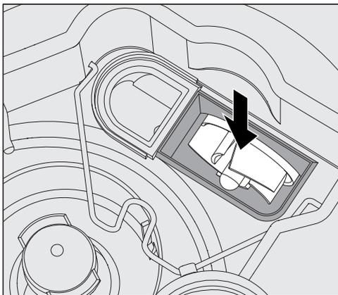
Sous le clapet anti-retour se trouve l'hélice de la pompe de vidange (flèche).
