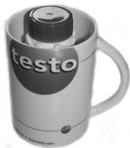
2. Chauffer de l'eau à env. 50 °C dans un récipient (p.ex. une tasse). Placer la bouteille d'huile de référence fermée dans ce bain d'eau pendant env. 10 min. (niveau d'eau au maximum à hauteur du bord inférieur du bouchon). Secouer ensuite brièvement la bouteille d'huile de référence fermée pour bien répartir la chaleur dans la bouteille.
