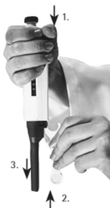
en soulevant légèrement le mécanisme de blocage (2).
