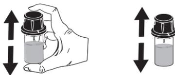
Afin d'éviter les fuites de réactifs et d'obtenir des mesures plus précises, fermez d'abord la cuvette avec le bouchon en plastique HDPE fourni
