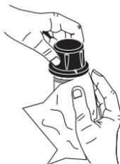
L'agitation de la cuvette peut générer des bulles dans l'échantillon, provoquant des lectures plus élevées. Pour obtenir des mesures précises, éliminer ces bulles en agitant ou en tapotant doucement sur la cuvette.
