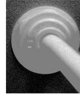
Pour déconnecter le tuyau, premièrement serrer la rondelle centrale de la pièce QC vers l'intérieur de la pièce et en même temps, tirer sur le tuyau en sens contraire.
