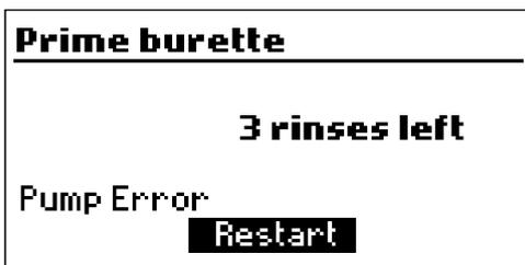
*Ce message d'erreur apparaît lorsque la pompe ne fonctionne pas correctement. Vérifiez le tube, la valve et la seringue. Appuyez sur **Restart** pour réessayer.*
