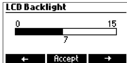
Utilisez les touches **FLECHES** ou ← / → pour incrémenter ou décrémenter le niveau de rétro-éclairage. Appuyez sur **Accept** pour confirmer ou **ESC** pour retourner au menu programmation.
