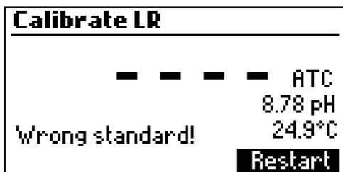
L'étalonnage est en-dehors des limites acceptables. Préparez une nouvelle solution standard et réessayez.
