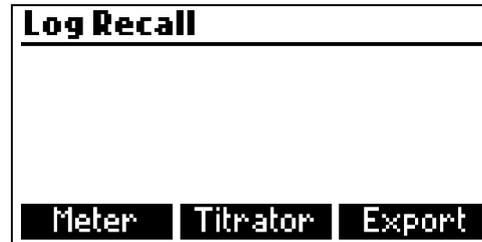
Si une clé de stockage USB est connectée à l'instrument, la touche **Export** est affichée et permet d'enregistrer 2 fichiers en format texte contenant les données du pH-mètre et du titreur.
