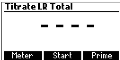
Cet écran s’affiche lorsque l’instrument est en mode titration. Appuyez sur **Start** pour commencer la titration, sur **Meter** pour entrer en mode pH-mètre ou **Prime** pour entrer dans la fonction amorçage.
