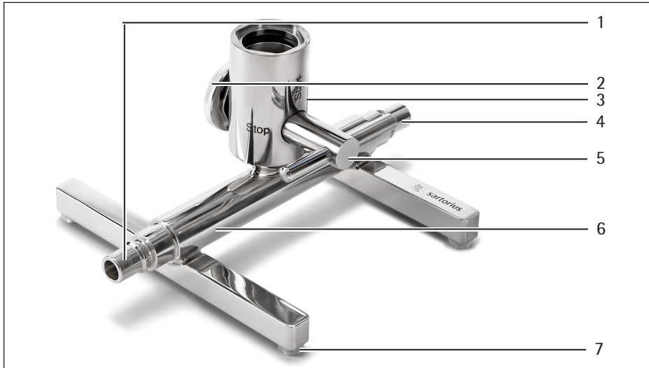
III.2 : Corps de la rampe à 1 poste (exemple)
