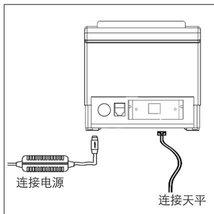
在按上图连接打印机之前，请进行检查，以确保打印机的电源开关处于关闭位置。
