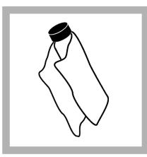
7. Brug den olierede klud til at påføre olien jævnt på prøvekvetternes overflade. Fjern overskydende olie. Sørg for, at prøvekvetterne er næsten tørre.
