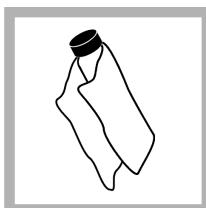
9. Verwenden Sie das Öltuch, um das Öl gleichmäßig auf die Oberfläche der Ampullen aufzutragen. Entfernen Sie den Großteil des Öls. Stellen Sie sicher, dass die Ampulle nahezu trocken ist.
