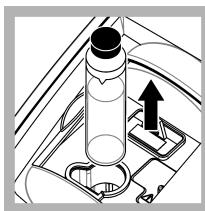
13. Otvorite poklopac i izvadite bočicu iz držača kivete za uzorak.
