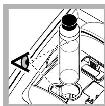
11. Setzen Sie die Ampulle so in den Küvettenenschacht, dass das Dreieck an der Ampulle mit der Referenzmarkierung am Küvettenenschacht übereinstimmt. Drücken Sie den Deckel nach unten, bis ein Klick zu hören ist.
