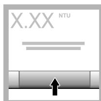
**8.** Stiskněte **Načítat**. Zobrazí se hodnota a úspěšnost nebo neúspěšnost ověření. Data se automaticky uloží v přístroji.
