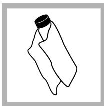
6. Gebruik de oliedoek om de olie gelijkmatig over het oppervlak van de kuvet aan te brengen. Verwijder het grootste deel van de olie. Zorg dat de kuvet bijna droog is.
