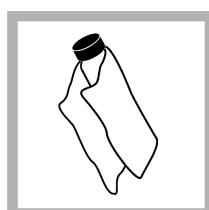
5. Čistěte kvety měkkým hadříkem, který nepoužíte vlákna, a odstraňte skvrny od vody a otisky prstů.
