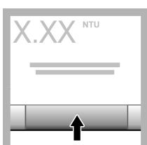
12. Pritisnite **Očitaj**. Prčekajte 1 minutu da instrument dovrši mjerenje.
