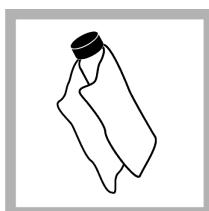
**6.** Utilize o pano de lubrificação para aplicar uniformemente o óleo na superfície da ampola. Remova a maioria do óleo. Certifique-se de que a ampola está praticamente seca.
