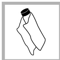
7. Brug den StabCal-standard, der vises på displayet. Rengør reaktionsglasset med en blød, frugtfri klud for at fjerne pleller fra vand og fingeraftryk.
