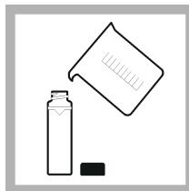
4. Skölj en ren och tom provkyvett två gånger med lösningen som ska analyseras och låt den lufttorka. Fyll på upp till linjen (ca 30 mL) med provlösning och sätt omedelbart på locket på cellen.
