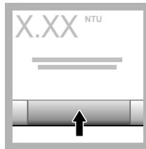
12. Nyomja meg az **Olvasás** gombot. Várjon 1 percet, amíg a műszer befejezi a mérést.
