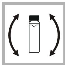
10. Inversez lentement et avec précaution la fiole pour mélanger entièrement l'étalon (n'inversez pas de fiole <0,1 NTU). Veillez à ne pas ajouter de bulles d'air.
