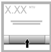
**16.** Pulse **Almacenar** para guardar los datos nuevos de la calibración.
