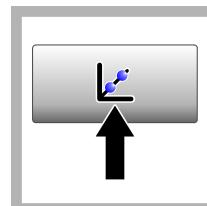
6. Tryk på **Calibration** (Kalibrering). Standardværdierne for den valgte kalibreringskurve (og verifikationsstandard, hvis Verificer efter kal. er slæbt til) vises på displayet. Hvis du vil vælge en anden kalibreringskurve, skal du se [Konfigurer kalibreringsindstillingerne](#) på side 190.
