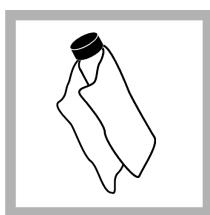
**9.** Använd den medföljande inoljningsduken för att applicera oljan jämnt över ytan på kivetten. Ta bort det mesta av oljan. Kontrollera att kivetten är nästan torr.
