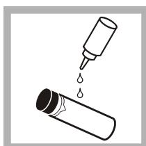
6. Aplikujte malé množstvo siličónového oleja rozotrite olej rovnomerne po povrchu meracích kyticet.
