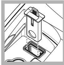
5. Tenere la linguetta del gruppo filtro USEPA in modo che le frecce siano rivolte verso la parte anteriore dello strumento. Spingere il gruppo filtro a fondo nell'alloggiamento.
