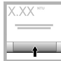
8. Naciągnąć przycisk **Read** (Wywołanie pomiaru). Zostanie wyświetlona wartość i status pomylnego lub niepomyślnego zakończenia weryfikacji. Dane zostaną automatycznie zapisane w pamięci aparatu.
