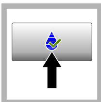
**3.** Натиснете **Проверка**. Извежда се стойността на стандарта за проверка. Натиснете **Опции\Настройка на проверка**, за да промените стойността на стандарта за проверка.
