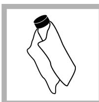
7. Připravte standard StabICal, který se zobrazuje na displeji. Kyvetu čistěte měkkým hadříkem, který nepouští vlákna, a odstraňte skvrny od vody a otisky prstů.
