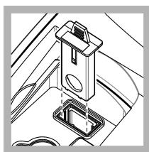
**5.** Håll USEPA filterenhetens flik så att pilarna pekar mot instrumentets framsida. Tryck in filterenheten tills den bottnar i huset.
