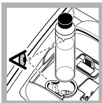
7. Vstavite vialo v nosilec za vzorčno kiveto tako, da je trikotnik na viali poravnан z referenčno oznako na nosilcu za vzorčno kiveto. S pritiskom zaprite pokrov, da zasišite klik.
