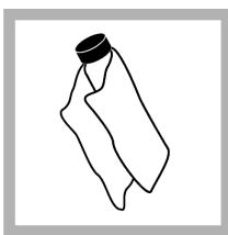
**7.** Vyberte si štandard StabICal, ktorý sa zobrazuje na displeji. Poutieraním jemnou tkaninou, z ktorej sa neuvolňujú vlákna, odstráňte z kyvety šmuhy od vody a odťačky prstov.
