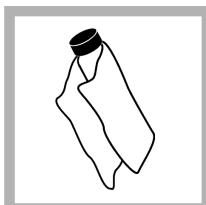
**9.** Χρησιμοποιήστε το πανί λίπανσης για να απλώσετε ορμούμορφα το λάδι στην επιφάνεια του φιαλίδιου. Αφαιρέστε το μεγαλύτερο μέρος του λαδιού. Βεβαιωθείτε ότι το φιαλίδιο έχει σχεδόν στεγνώσει.
