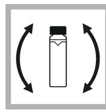
8. Nježno i polako preokrenite kivetu za uzorak za potpuno miješanje uzorka. Pazite da ne dodate mjehuriće zraka.
