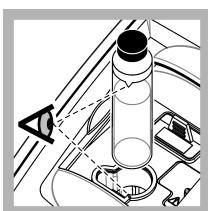
**7. Asetage viaal prooviküveti hoidikusse nii, et viaali kolmnurk on joondatud prooviküveti hoidiku viitemärgiga.** Suruge kaant kinni, kumi kuulete klöpsu.
