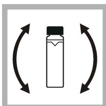
8. Inversez lentement et avec précautions la cuve d'échantillon pour mélanger complètement l'échantillon. Veillez à ne pas ajouter de bulles d'air.
