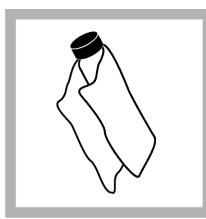
5. Rengör provkyvettarna med en mjuk, luddfri trasa för att avlägsna vattenfläckar och fingeravtryck.
