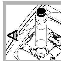
7. Umieścić fiolkę w gnieździe pomiarowym tak, aby trójkąt na fiolce pokrywał się ze znacznikiem odniesienia na gnieździe pomiarowym. Zamknąć pokrywę, naciśkając na nią do chwili usłyszenia charakterystycznego kliknięcia.
