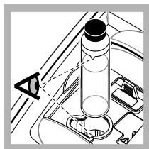
9. Introduceți celula de probă în suportul pentru celule de probă cu triunghiul de pe celula de probă aliniat cu marcajul de referință de pe suportul de celule de probă. Apăsați capacul până se închide cu un clic.
