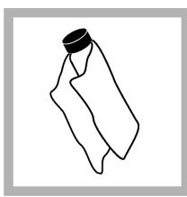
7. Använd den medföljande inoljningsduken för att applicera oljan jämnt på provkyvettarnas yta. Ta bort överflödig olja. Se till att provkyvettarna nästan är torra.
