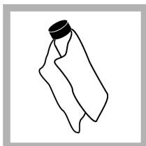
9. Za pomocą szmatki do naoliwiania rozsmarować olej równomiernie na całej powierzchni kuvety. Usunąć nadmiar oleju. Upewnić się, że fiolka jest prawie sucha.
