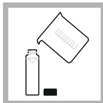
4. Skyl en ren, tom prøvekvette to gange med opløsningen, og dræn ned i en affaldsbeholder. Fyld op til linjen (ca. 30 mL) med prøve og sæt med det samme låg på prøvekvetten.
