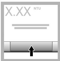
**15.** Als Verify after Cal (controle na kalibratie) is ingeschakeld, wordt de waarde van de controlestandaard weergegeven. Druk op **Read (meten)** om de controlestandaard te meten.
