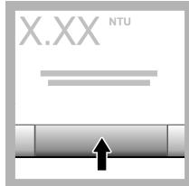
15. Si l'option Vérifier après Cal est activée, la valeur de l'étalon de vérification s'affiche. Appuyez sur Mesurer pour mesurer l'étalon de vérification.
