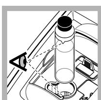
11. Bočicu stavite u držać kivete za uzorak s trokutom na bočici poravnatim s referentom ozнаком na držaću bočica za uzorak. Pritisnite poklopac za zatvaranje dok ne čujete škljocaj.
