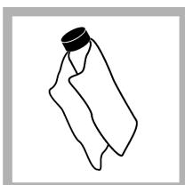
7. Utilisez le chiffon de huile fourni pour appliquer l'huile uniformément sur la surface des cuves. Retirez l'excès d'huile. Vérifiez que les cuves sont presque sèches.
