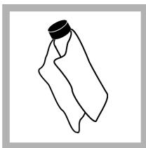
**7.** Utilice el paño lubricante suministrado para aplicar el aceite de forma uniforme por la superficie de las cubetas de muestra. Elimine el exceso de aceite. Asegúrese de que las cubetas de muestra estén casi secas.
