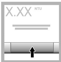
**10.** Нажмите **Read** (**Измерение**) (или **Done** (**Выполнено**)) в непрерывном режиме). Подождите, пока прибор проведет измерение пробы.
