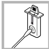
**4. USEPA filtre düzeneğinin lensini temizleyin. Bkz. [Filtre aksaminin temizlenmesi](#) sayfa 396.**
