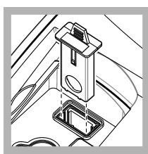
**5.** Țineți protuberanța ansamblului filtrului USEPA cu săgețile îndreptate spre partea frontală a instrumentului. Apăsați ansamblul filtrului în carcasa până la capăt.
