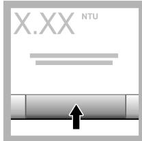
**15.** Je-li volba **Ověřit** po kalibraci zapnutá, zobrazi se hodnota kontrolního standardu. Stiskněte volbu **Načíst** pro změření kontrolního standardu.
