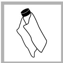
**6.** Utilizzare il panno lubrificante per applicare l'olio in modo uniforme sulla superficie della fiala. Rimuovere la maggior parte dell'olio. Verificare che la fiala sia quasi asciutta.
