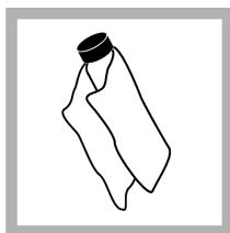
**9.** Pomocou utierky na roztieranie oleja roztráňte olej rovnomerne po povrchu kyvety. Zotrite nadbytočný olej. Uistite sa, že kyveta je takmer suchá.
