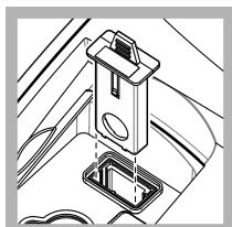
5. Držite jezičak sklopa filtra USEPA tako da strelice pokazuju prema prednjem dijelu instrumenta. Sklop filtra gurnite u cijelosti u kućište.
