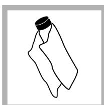
5. Reinigen Sie die Probenküvetten mit einem weichen, fussel-freien Tuch, um Wasserflecken und Fingerabdrücke zu entfernen.
