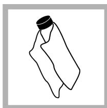
7. Χρησιμοποιήστε το παρεχόμενο πανί λίπανσης για να απλώσετε ομοιόμορφα το λάδι στην επιφάνεια των κυψελίδων δείγματος. Αφαιρέστε την περίσσεια λαδιού. Βεβαιωθείτε ότι οι κυψελίδες δείγματος είναι σχεδόν στεγνές.
