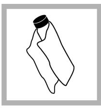
7. Dostavljenom nauljenom krpom ravnomjerno nanesite ulje na površinu kivete za uzorak. Uklonite višak ulja. Provjerite jesu li kivete za uzorak gotovo suhe.
