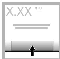
**12. Πατήστε Μέτρηση.** Περιμένετε 1 λεπτό μέχρι το όργανο να ολοκληρώσει τη μέτρηση.
