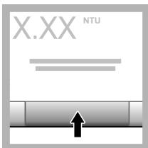
15. Dacă este activată Verificare după calibrare, se afișează valoarea soluției etalon de verificare. Apăsați **Read (Citire)** pentru a măsura soluția etalon de verificare.
