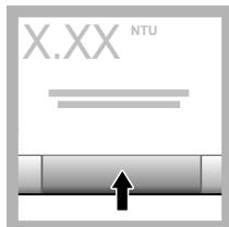
10. **Read (Oku)** öğesine (veya sürekli moddaşa **Done (Bitti)** öğesine) basın. Cihazın numuneyi okumasını bekleyin.
