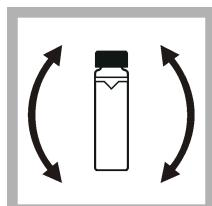
10. Previdno in počasi obrnite viale, da popolnoma zmešate standard (ne obrnite viale < 0,1 NTU). Bodite previdni, da ne dodate zračnih mehurčkov.
