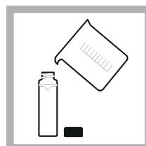
4. Enjuague una cubeta de muestra dos veces con la solución que se vaya a medir y déjela secar completamente. Llene la cubeta de muestra hasta la línea (aprox. 30 ml) con muestra y coloque inmediatamente el tapón de la cubeta.
