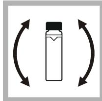
8. Întoarceți ușor și lent celulele de probă cu capul în jos pentru a amesteca complet proba. Aveți grijă să nu adăugați bule de aer.
