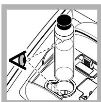
**7.** Coloque a ampola no suporte de células de amostra com o triângulo na ampola alinhado com a marca de referência no suporte de células de amostra. Prima a tampa para a fechar até ouvir um clique.
