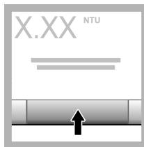
8. Druk op de toets **Read (lezen)**. De waarde en de status (geslaagd of mislukt) worden weergegeven. De gegevens worden automatisch in het instrument opgeslagen.
