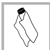
7. Utilizzare il panno lubrificante fornito per applicare l'olio in modo uniforme sulla superficie delle celle campione. Rimuovere l'olio in eccesso. Assicurarsi che la cella campione sia quasi asciutta.
