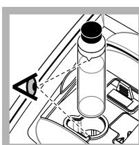
11. Vložte kyvetu do držáku na kyvety tak, aby trojúhelník na kyvetě byl zarovnaný podle referenční značky na držáku kyvet. Zatlačujte víko, dokud neuslyšíte cvaknutí.
