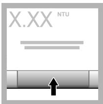
15. W przypadku włączenia opcji Verify after Cal (Zweryfuj po kalibracji) zostaje wyświetlona wartość wzorca weryfikacyjnego. Naciśnąć przycisk **Read** (Wywołanie pomiaru), aby wykonać pomiar wzorca weryfikacyjnego.
