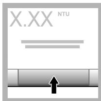
15. Hvis Verificer efter kal. er slægt til, vises værdien af verifikationsstandarden. Tryk på **Aflæs** for at måle verifikationsstandarden.
