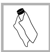
7. Λάβετε το πρότυπο StabICal που εμφανίζεται στην οθόνη. Καθαρίστε το φιαλίδιο με ένα μαλακό πανί που δεν αφήνει χνούδι για να αφαιρέσετε τυχόν σταγόνες νερού και δακτυλικά αποτυπώματα.
