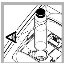
**11.** Τοποθετήστε το φιαλίδιο στον υποδοχέα κυψελίδας δείγματος έτσι ώστε το τρίγωνο που βρίσκεται στο φιαλίδιο να είναι ευθυγραμμισμένο με το σημεδι άναφοράς στον υποδοχέα κυψελίδας δείγματος. Πατήστε το καπάκι μέχρι να κλείσει και να ακουστεί ένας ήχος "κλικ".
