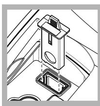
5. Pidä USEPA-suodattimen liuskaa niin, että nuolet osoittavat kohti laitteesta etuosaan. Työnny suodatin kokonaan koteloon.
