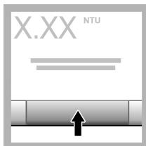
12. Nacisnąć przycisk **Read** (Wywołanie pomiaru). Odczekać 1 minutę aż aparat zakonczy wykonywanie pomiaru.
