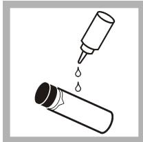
6. Aplicați o linie subțire de ulei siliconic din partea de sus până la partea de jos a celulelor de probă.
