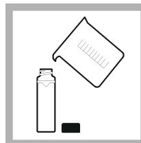
**4. Ölçüm yapılacak temiz ve boş numune hücresinin çözelti ile durulayın ve atığı atın.** Numune hücresinin üzerindeki çizgiye kadar (yaklaşık 30 mL) numune ile doldurun, kapağını hemen kapatın.
