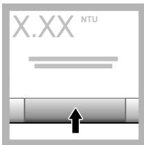
15. Wenn „Verif. nach Kalib.“ aktiviert ist, wird der Wert des Verifikationsstandards angezeigt. Drücken Sie **Messen**, um den Verifikationsstandard zu messen.
