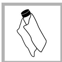
5. Poutieraním jemnou tkaninou, z ktorej sa neuvolňujú vlákna, odstráňte z meracích kyticet šmuhy od vody a odtlačky prstov.
