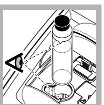
7. Placer reaktionsglasset i prøvekuvetteholderen med trekanten på reaktionsglasset justeret efter referencemærket på prøvekuvetteholderen. Tryk låget til, indtil der høres et klik.
