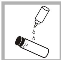
5. Tragen Sie von der Oberkante der Ampulle zur Unterseite hin einen Tropfen Silikonöl auf.
