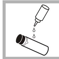
8. Tragen Sie von der Oberkante der Ampulle zur Unterseite hin einen Tropfen Silikonöl auf.
