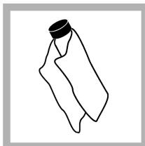
6. Yağı vialin yüzeyine eşit olarak dağıtmak için yağlama bezini kullanın. Yağınlığını uzaklaştırır. Vialin neredeyse kuru olduğundan emin olun.
