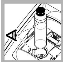
**11.** Coloque el vial en el soporte de cubetas de muestra con el triángulo del vial alineado con la marca de referencia del soporte de cubetas. Presione la tapa, que quedará cerrada cuando oiga un clic.
