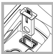
5. Держите язычок узла фильтра USEPA так, чтобы стрелки на нем указывали на переднюю часть прибора. Нажмите на узел фильтра так, чтобы он полностью вошел в корпус.
