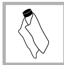
4. Poutieraním jemnej tkaninou, z ktorej sa neuvoľňujú vlákna, odstráňte z kyvety Gelex šmyhy od vody a odtlačky prstov.
