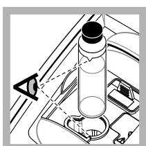
7. Boćicu stavite u držač kivete za uzorak s trokutom na bočici poravnatim s referentom oznakom na držaču boćica za uzorak. Pritisnite poklopac za zatvaranje dok ne čujete šklijocaj.
