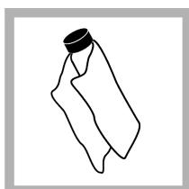
**7. Hankige ebraanil kuvatav StabICal standard. Puhastage viaal pehme ja ebemevaba lapiga, et eemaldada vee- ja sõrmejäljed.**
