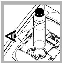
11. Introduceți flaconul în suportul pentru celule de probă cu triunghiul de pe flacon aliniat cu marcasajul de referință de pe suportul de celule de probă. Apăsați capacul până se închide cu un clic.
