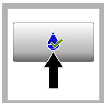
3. Naciśnąć przycisk **Verification** (Weryfikacja). Zostanie wyświetlona wartość wzorca weryfikacyjnego. Naciśnąć kolejno **Options>Verification Setup** (Opcje>Konfiguracja weryfikacji), aby zmienić wartość wzorca weryfikacyjnego.
