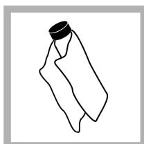
5. Nettoyez les cuves avec un chiffon doux non pelucheux pour éliminer les traces d'eau et de doigts.
