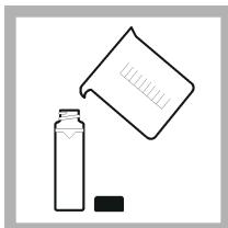
4. Čisto, prazno vzorčno kiveto dvakrat izperite z raztopino, ki jo želite izmeriti, in jo odtočite med odpadke. Vzorčno kiveto napolnite z vzorcem do črte (približno 30 mL) in jo takoj zaprite s pokrovčkom.
