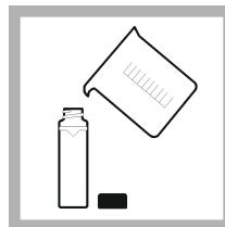
4. Spülen Sie eine saubere, leere Probenküvette zweimal mit der zu messenden Lösung und leeren Sie sie dann vollständig aus. Füllen Sie sie bis zur Linie (etwa 30 ml) mit der Probe und schrauben Sie sofort die Kappe auf die Probenküvette.
