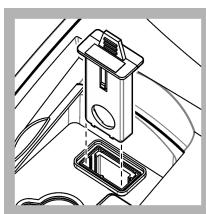
5. Хванете езичето на филтърния модул USEPA така, че стрелките да сочат към предната част на прибора. Натиснете филтърния модул напълно в корпуса.
