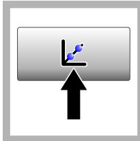
6. Drücken Sie **Kalibrierung**. Die Standardwerte für die ausgewählte Kalibrierkurve (und den Verifikationssstandard, wenn „Verif. nach Kalib.“ aktiviert ist) werden auf dem Display angezeigt. Informationen zur Auswahl einer anderen Kalibrierkurve finden Sie unter [Konfigurieren der Kalibrierereinstellungen](#) auf Seite 35.
