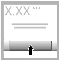
**10.** Pulse **Medición** (o **Hecho**, si se encuentra en el modo continuo). Espere hasta que el instrumento mida la muestra.
