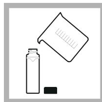
4. Čistú a prázdnu meraciu kyvetu dvakrát prepláchnite meranou vzorkou a vylejte do odpadu. Meraciu kyvetu naplňte po rysku (približne 30 ml) vzorkou a okamžite ju zazátkujte.
