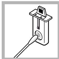
4. Puhdista USEPA-suodattimen linssi. Katso kohta **Suodattimen puhdistus** sivulla 261.
