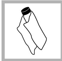
7. Utilizați cărpă de ungere furnizată pentru a aplica ulei în mod uniform pe suprafața celulelor de probă. Îndepărtați excesul de ulei. Asigurați-vă că celulele de probă sunt aproape uscate.
