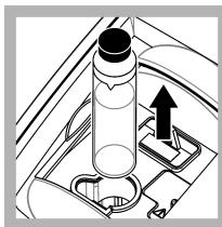
13. Öppna locket och ta bort kyvetten från provkyttshållaren.
