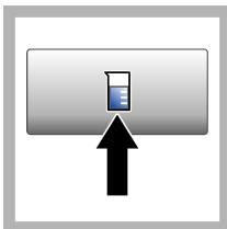
3. Drücken Sie **Proben-ID**. Wählen Sie die entsprechende Proben-ID und drücken Sie dann **Auswahl**. Die ausgewählte Proben-ID wird auf dem Display angezeigt.
