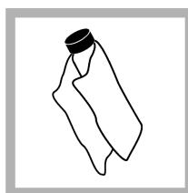
6. С помощью ткани для смазывания равномерно распределите масло по поверхности пробирки. Удалите большую часть масла. Убедитесь, что пробирка почти сухая.
