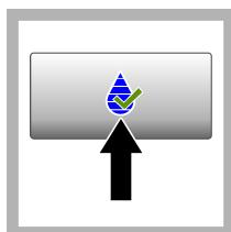
3. Nyomja meg a **Verification (Ellenőrzés)** gombot. Megjelenik az ellenőrző szabvány értéke. Nyomja meg az **Options (Opciók) > Verification Setup (Ellenőrzés beállítása)** gombot az ellenőrző szabvány értékének módosításához.
