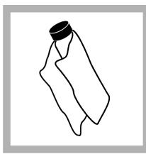
9. Hankaa öljyliinalla öljy tasaisesti injektiopullen pintaan. Poista suuri osa öljystä. Varmista, että injektiopullo on lähes kuiva.
