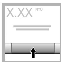
8. Pulse **Medición**. Se muestra el valor e información sobre si se ha superado correctamente la medición. Los datos se almacenan automáticamente en el instrumento.
