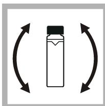
10. Schwenken Sie die Ampulle vorsichtig und langsam um, um den Standard vollständig zu mischen (schwenken Sie die < 0,1 NTU-Ampulle nicht). Achten Sie darauf, dass keine Luftpblasen entstehen.
