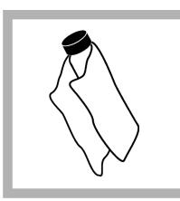
7. Vzemite standard StabCal, ki je prikazan na zaslonu. Očistite viale z mehko, gladko krpo, da odstranite sledi vode in prstne odтise.
