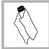
7. Nehmen Sie den StabCal Standard, der auf dem Display angezeigt wird. Reinigen Sie die Ampulle mit einem weichen, fusselfreien Tuch, um Wasserflecken und Fingerabdrücke zu entfernen.
