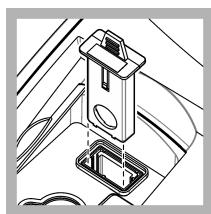
**5. USEPA filtre düzeneğinin üç kısmındaki şeridi oklar cihazın ön tarafını gösterecek şekilde tutun. Filtre düzeneğini yuvaya tam olarak yerleşecek şekilde itin.**
