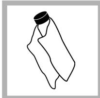
**9.** Gebruik de oliedoek om de olie gelijkmataig op het oppervlak van de kuvet aan te brengen. Verwijder het grootste deel van de olie. Zorg dat de kuvet bijna droog is.
