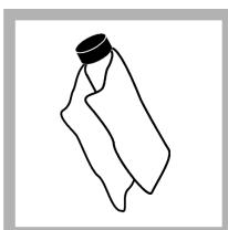
**7. Yağı numune hücrelerinin yüzeyine eşit olarak dağıtmak için sağlanan yağlama bezini kullanın. Fazla yağı temizleyin.** Numune hücrelerinin neredeyse kuru olduğundan emin olun.
