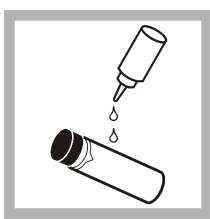
**8.** Aplicați o picătură mică de ulei siliconic din partea de sus până la partea de jos a flaconului.
