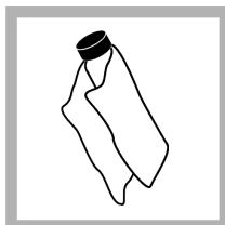
5. Očistite vzorčne kivete z mehko, gladko krpo, da odstranite sledi vode in prstne odtise.
