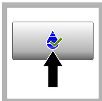
**3. Apăsați Verification (Verificare). Se afișează valoarea soluției etalon de verificare. Apăsați Opțiuni >Verification Setup (Configurare verificare) pentru a schimba valoarea soluției etalon de verificare.**
