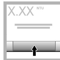
8. Read (Oku) öğesine basın. Değer ve geçme veya kalma durumu gösterilir. Veriler cihazda otomatik olarak saklanır.
