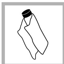
9. Brug oliekluden til at påføre olien jævnt på reaktionsglasset. Fjern det meste af olien. Sørg for, at reaktionsglasset er næsten tørt.
