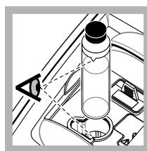
**9. Aseta näytekynetti näytekynettiin pidikkeeseen niin, että näytekynetti kolmio on kohdistettu näytekynettiin pidikkeen vertailumerkin kanssa. Paina kantta kiinni, kunnes kuuluu naksahdus.**
