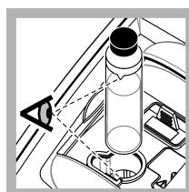
7. Coloque el vial en el soporte de cubetas de muestra con el triángulo del vial alineado con la marca de referencia del soporte de cubetas. Presione la tapa, que quedará cerrada cuando oiga un clic.
