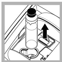
13. Abra a tampa e remova o suporte de células de amostra.
