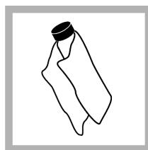
5. Puustage prooviküvetid pehme ja ebemevaba lapiga, et eemaldada vee- ja sõrmejäljed.
