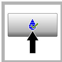
**3.** Stiskněte volbu **Ověření**. Zobrazí se hodnota kontrolního standardu. Stiskněte volbu **Možnosti > Nastavení ověření** a změňte hodnotu kontrolního standardu.
