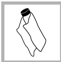
**6.** Pomocou utierky na roztieranie oleja rozotrite olej rovnomerne po povrchu kyvety. Zotrite nadbytočný olej. Uistite sa, že kyveta je takmer suchá.
