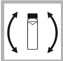
**10.** Keer de kuvet langzaam en voorzichtig om om de standaard volledig te mengen (keer de kuvet met <0,1 NTU niet om). Pas op dat u geen luchtbellen toevoegt.
