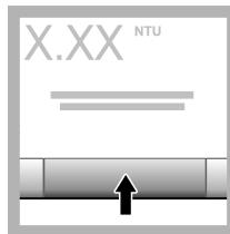
15. Om verifiera efter kal. är påslaget visas verifieringsstandardens värde. Tryck på Läs för att mäta verifieringsstandarden.
