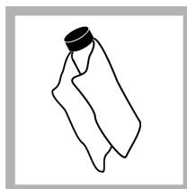
4. Reinigen Sie die Gelex-Ampullen mit einem weichen, fusselfreien Tuch, um Wasserflecken und Fingerabdrücke zu entfernen.
