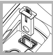
5. Laikykite USEPA filtro konstrukcijos auselę taip, kad rodyklės būtų nukreiptos į prietaiso priežiūrą. Ištumkite filtro konstrukciją iki galio į korpusą.
