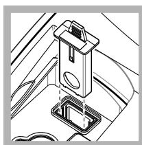
**5. Segure na patilha do conjunto do filtro USEPA** de forma a que as setas apontem na direcção da parte da frente do instrumento. Empurre o conjunto do filtro até encaixar completamente na estrutura.
