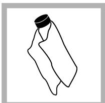
7. Utilize o pano de lubrificação fornecido para distribuir uniformemente o óleo na superfície das células de amostra. Remova o óleo em excesso. Certifique-se de que as células de amostra estão praticamente secas.
