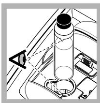
7. Placerar kyvetten i provkyttshållaren med triangeln på kyvetten i linje med referensmarkeringen på provkyttshållaren. Tryck fast locket tills du hör ett klick.
