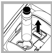
13. Öffnen Sie den Deckel und entnehmen Sie die Ampulle aus dem Küvettenschacht.
