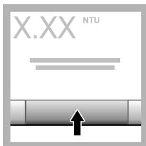
15. Se a Verificação após a Calibração estiver definida como ligada, o valor do padrão de verificação é apresentado. Prima Ler para medir o padrão de verificação.
