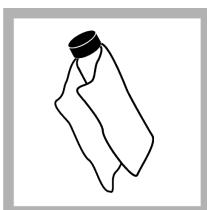
7. Za pomocą dostarczonej szmatki naoliwiania rozsmarować olej równomiernie na całej powierzchni kuwety. Usunąć nadmiar oleju. Upewnić się, że kuweta jest prawie sucha.
