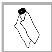
6. Utilice el paño lubricante para aplicar el aceite de forma uniforme por la superficie del vial. Retire la mayor parte del aceite. Asegúrese de que el vial esté casi seco.
