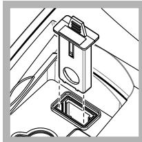
5. Halten Sie den USE-PA-Filter so, dass die Pfeile in Richtung der Vorderseite des Geräts zeigen. Drücken Sie den Filter komplett in das Gehäuse.
