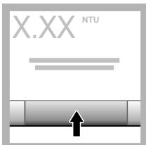
15. Если функция Verify after Cal (Проверка после калибровки) включена, отображается значение эталона для проверки. Нажмите **Read** (Измерение) для измерения эталона для проверки.
