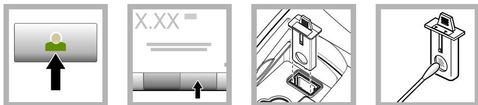
1. Appuyez sur Connexion et sélectionnez l'ID opérateur applicable. Si la connexion n'est pas nécessaire, passez à l'étape 3.
