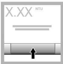
15. Ak je zapnuté overenie po kalibrácii, zobrazí sa hodnota overovacieho štandardu. Stlačením položky **Načítať** odmerajte overovací štandard.
