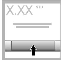
15. Se è attivata l'opzione Verifica dopo cal, viene visualizzato lo standard di verifica. Premere Leggi per misurare lo standard di verifica.
