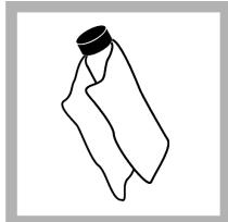
**9.** Utilice el paño lubricante para aplicar el aceite de forma uniforme por la superficie del vial. Retire la mayor parte del aceite. Asegúrese de que el vial esté casi seco.
