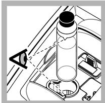
**11.** Steek de kuvet in de meetschacht met de driehoek op de kuvet uitgelijnd met de markering op de meetschacht. Druk het deksel dicht totdat u een klik hoort.
