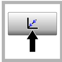
6. Paspauskite Calibration (Kalibravimas). Ekrane parodomos standartinės pasirinktos kalibravimo kreivės vertės (ir tikrinimo standartas, jei įjungta parinktis „Verify after Cal“ (Tikrinti po kalibravimo)). Norėdami pasirinkti kitą kalibravimo kreivę, žr. Kalibravimo nustatymų konfigūracijos puslapį 344.
