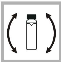
10. Inversați flaconul cu atenție și fără să vă grăbiți, pentru ca soluția etalon să se amestice bine (nu inversați flaconul <0,1 NTU). Aveți grijă să nu adăugați bule de aer.
