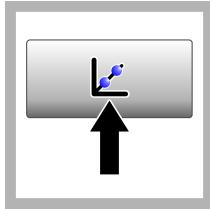
6. Premere **Calibrazione**. Sul display vengono visualizzati i valori standard per la curva di calibrazione selezionata (e lo standard di verifica, se è attiva l'opzione Verifica dopo cal). Per selezionare una curva di calibrazione diversa, fare riferimento a [Configurazione delle impostazioni di calibrazione](#) a pagina 58.
