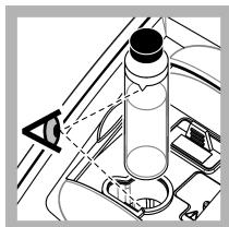
**9.** Placer prøvekuvetten i prøvekuvetteholderen med trekanten på prøvekuvetten justeret efter referencemærket på prøvekuvetteholderen. Tryk låget til, indtil der høres et klik.
