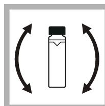
**8. Numuneyi tam olarak karıştırmak için numune hücresinin hafifçe ve yavaşça ters çevirin. Hava balonculukları oluşmaması için dikkatli olun.**
