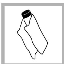
**6.** K rovnoramennému nanesení oleje použijte olejovací hadřík. Odstraňte většinu oleje. Zkontrolujte, že je kyveta téměř suchá.
