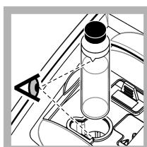
**7.** Vložte kyvetu do držáku na kytic tak, aby trojúhelník na kyvete byl zarovnán podle referenční značky na držáku kyvet. Zatlačte víko, dokud neuslyšíte cvaknutí.
