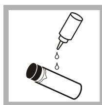
**5. Aplicați o picătură mică de ulei siliconic din partea de sus până la partea de jos a flaconului.**
