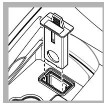
3. Снимите узел фильтра.
