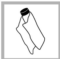
6. Verwenden Sie das Öltuch, um das Öl gleichmäßig auf die Oberfläche der Ampullen aufzutragen. Entfernen Sie den Großteil des Öls. Stellen Sie sicher, dass die Ampulle nahezu trocken ist.
