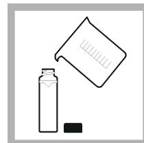
4. Čistu, praznu kivetu za uzorak dvaput isperite otopinom koja će se mjeriti i izbacite u otpad. Napunite do crte (približno 30 mL) s uzorkom i odmah začepite kivetu za uzorak.
