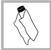
7. Przygotować wzorzec StabCal o wartości wyświetlanej na ekranie. Wyczyścić fiolkę miękką, niestrzepiącą się szmatką, aby usunąć plamy wody i odciski palców.
