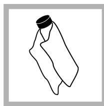
**7.** Hämta den StabICal-standard som visas på displayen. Rengör kivetten med en mjuk, luddfri trasa för att avlägsna vattenflackar och fingeravtryck.
