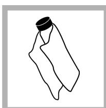
9. K rovnoměrnému nanesení oleje na povrch kyvetu použijte olejovací hadřík. Odstraňte většinu oleje. Zkontrolujte, že je kyveta téměř suchá.
