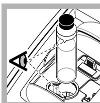
11. Vставite viale v nosilec za vzorčno kiveto tako, da je trikotnik na vialei poravnан z referenčno označo na nosilcu za vzorčno kiveto. S pritiskom zaprite pokrov, da zasišite klik.
