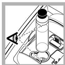
7. Placez la fiole dans le porte-cuve en alignant le triangle sur la fiole avec le repère du porte-cuve. Appuyez sur le couvercle jusqu'à ce qu'un clic retentisse.
