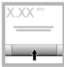
12. Paina **lukunäppäintä**. Odota minuutti, jotta laite saa mittauksen valmiaksi.
