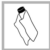
4. Nettoyez les fioles Gelex avec un chiffon doux non pelucheux pour éliminer les traces d'eau et de doigts.
