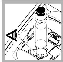
11. Asetage viaal prooviküveti hoidikusse nii, et viaali kolmnurk on joondatud prooviküveti hoidiku viitemärgiga. Suruge kaant kinni, kumi kuulete klõpsu.
