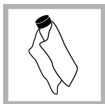
5. Καθαρίστε τις κυψελίδες δείγματος με ένα μαλακό πανί που δεν αφήνει χρούδι για να αφαιρέσετε τυχόν σταγόνες νερού και δακτυλικά αποτυπώματα.
