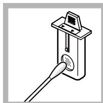
4. Tisztítsa meg az USEPA szűrőszerelemből lencséjét. Lásd: [A szűrőszerelemből tisztítása](#) oldalon 307.
