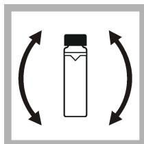
10. Inverta a ampola de forma lenta e cuidadosa para misturar completamente o padrão (não inverta a ampola <0,1 NTU). Tenha cuidado para não adicionar bolhas de ar.
