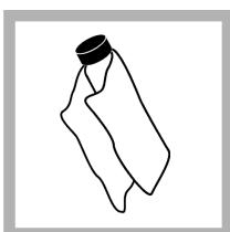
7. Pomocou dodanej utierky na rozteranie oleja rozotrite olej rovnomerne po povrchu meracích kyticet. Zotrite nadbytočný olej. Uistite sa, že meracie kyticet sú takmer suché.
