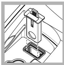
5. Tenez la languette de l'ensemble de filtre USEPA pour que la flèche soit orientée vers l'avant de l'instrument. Enfoncez complètement l'ensemble de filtre dans le boîtier.
