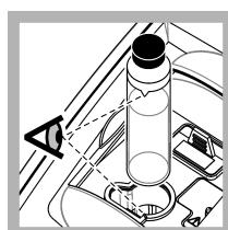
9. Vložte kyvetu do držáku na kvety tak, aby trojúhelník na kyvete byl zarovnaný podle referenční známký na držáku kyvet. Zatlačujte víko, dokud neuslyšíte cvaknutí.
