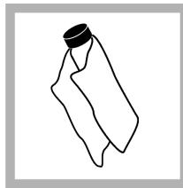
4. Reinig de Gelex-kvetten met een zachte, niet-pluizende doek om watervlekken en vingerafdrukken te verwijderen.
