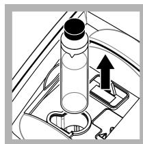
**13.** Open het deksel en verwijder de kuvet uit de meetschacht.
