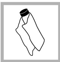
6. Använd den medföljande inlösningsduken för att applicera oljan jämnt över ytan på kyvetten. Ta bort det mesta av oljan. Kontrollera att kyvetten är nästan torr.
