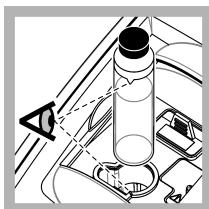
11. Coloque a ampola no suporte de células de amostra com o triângulo na ampola alinhado com a marca de referência no suporte de células de amostra. Prima a tampa para a fechar até ouvir um clique.
