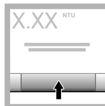
12. Drücken Sie **Read** (Messen). Warten Sie eine Minute, bis das Gerät die Messung abgeschlossen hat.
