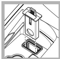
**3. Filtre düzeneğini çıkartın.**
