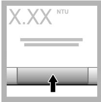
15. Verify after Cal (Kalibrasyondan Sonra Doğrula) seçeneği açıksa doğrulama standartı değeri gösterilir. Doğrulama standartını ölçmek için **Read (Oku)** öğesine basın.
