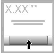
**12.** Pulse **Medición**. Espere 1 minuto hasta que el instrumento finalice la medición.
