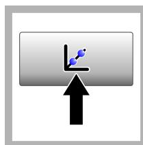
6. Pulse **Calibración**. Los valores estándar de la curva de calibración seleccionada (y el estándar de verificación, si Verificar tras cal. está activada) se muestran en la pantalla. Para seleccionar una curva de calibración diferente, consulte [Configuración de los ajustes de calibración](#) en la página 103.
