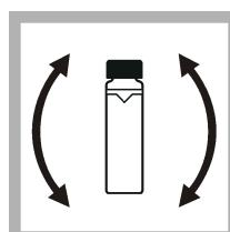
8. Schwenken Sie die Probenküvette vorsichtig und langsam um, um die Probe vollständig zu mischen. Achten Sie darauf, dass keine Luftblasen entstehen.
