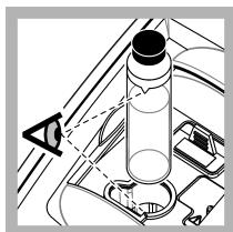
9. Kivetu za uzorak stavite u držać kiveta za uzorak s trokutom na kiveti za uzorak poravnatim s referentnom oznakom na držaču kivete za uzorak. Pritisnite poklopac za zatvaranje dok ne čujete škljocaj.
