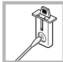
4. Очистите линзу узла фильтра USEPA. См. [Очистите узел фильтра](#) на стр. 375.
