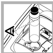
9. Coloque a célula de amostra no suporte de células de amostra com o triângulo na célula de amostra alinhado com a marca de referência no suporte de células de amostra. Prima a tampa para fechar até ouvir um clique.
