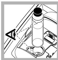
**9.** Coloque la cubeta de muestra en el soporte de cubetas con el triángulo de la cubeta alineado con la marca de referencia del soporte de cubeta de muestra. Presione la tapa, que quedará cerrada cuando oiga un clic.
