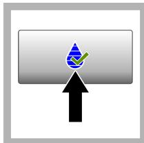
3. Pritisnite **Verification** (Preverjanje). Prikaže se vrednost standardna preverjanja. Pritisnite **Options>Verification Setup** (Možnosti>Nastavitev preverjanja), da spremenite vrednost standarda preverjanja.
