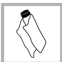
7. Verwenden Sie das im Lieferumfang enthaltene Öltuch, um das Öl gleichmäßig auf die Oberfläche der Probenküvetten aufzutragen. Entfernen Sie überschüssiges Öl. Stellen Sie sicher, dass die Probenküvetten nahezu trocken sind.
