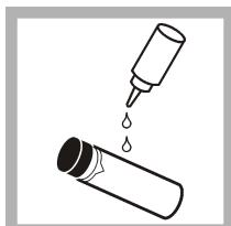
6. Aplique uma pequena gota de óleo de silicone nas células de amostra, de cima para baixo.
