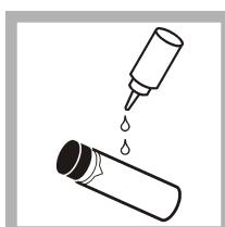
6. Tragen Sie von der Oberkante der Probenküvetten zur Unterseite hin wenig Silikonöl auf.
