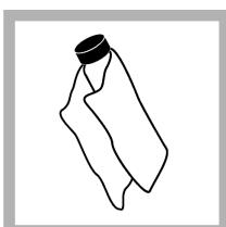
6. Brug oliekluden til at påføre olien jævnt på reaktionsglasset. Fjern det meste af olien. Sørg for, at reaktionsglasset er næsten tørt.
