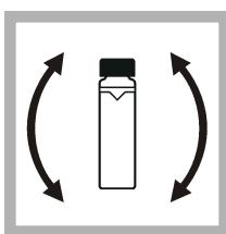
**10.** Lossa försiktigt och invertera kivetten långsamt för att blanda standarden helt (invertera inte <0,1 NTU-kivetten). Var försiktig så att inte luftbubblor bildas.
