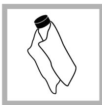
**7. Hankaa öljyä** öljymäisiinalla öljy tasaisesti näytekynettiin pintaan. Poista ylimääräinen öljy. Varmista, että näytekynetit ovat lähes kuivia.
