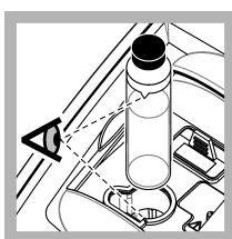
**7. Introduceți flaconul în suportul pentru celule de probă cu triunghiul de pe flacon aliniat cu marcajul de referință de pe suportul de celule de probă. Apăsați capacul până se închide cu un clic.**
