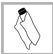
9. Utilizzare il panno lubrificante per applicare l'olio in modo uniforme sulla superficie della fiala. Rimuovere la maggior parte dell'olio. Verificare che la fiala sia quasi asciutta.
