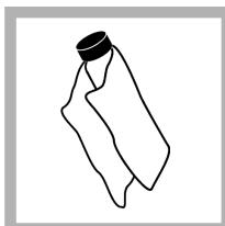
9. С помощью ткани для смазывания равномерно распределите масло по поверхности пробирки. Удалите большую часть масла. Убедитесь, что пробирка почти сухая.
