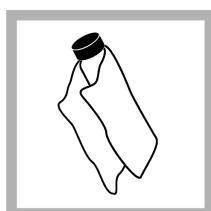
6. Nauljenom krpom ulje ravnomjerno nanesite po površini boćice. Uklonite većinu ulja. Uverite se da je boćica gotovo suha.
