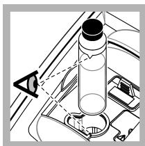
11. Placez la fiole dans le porte-cuve en alignant le triangle sur la fiole avec le repère du porte-cuve. Appuyez sur le couvercle jusqu'à ce qu'un clic retentisse.
