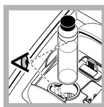
**11.** Placer kivetten i provkivetshållaren med triangeln på kivetten i linje med referensmarkeringen på provkivetshållaren. Tryck fast locket tills du hör ett klick.
