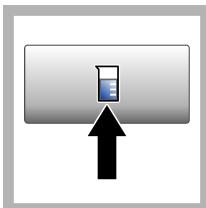
**3. Sample ID** (Numune Kimliği) öğesine basın. Geçerli numune kimliğini seçip **Select** (Seç) öğesine basın. Seçilen numune kimliği ekranda gösterilir.
