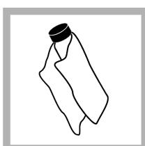
7. K rovnoměrnému nanesení oleje na povrch kyvet použijte olejovací hadík. Odstraňte přebytečný olej. Dbejte, aby byly kvety téměř suché.
