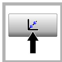
**6. Prima Calibração.** Os valores de padrão para a curva de calibração seleccionada (e padrão de verificação, caso a Verificação após a Calibração se encontre ligada) são apresentados no ecrã. Para seleccionar uma curva de calibração diferente, consulte [Configurar as definições da calibração](#) na página 125.
