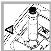
11. Umieścić fiolkę w gnieździe pomiarowym tak, aby trójkąt na fiolce pokrywał się ze znacznikiem odniesienia na gnieździe pomiarowym. Zamknąć pokrywę, naciskając na nią do chwili usłyszenia charakterystycznego kliknięcia.
