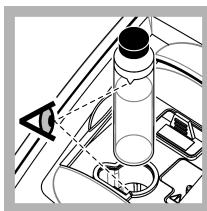
7. Steek de kuvet in de meetkanaal met de driehoek op de kuvet uitgelijnd met de markering op de meetkanaal. Druk het deksel dicht totdat u een klik hoort.
