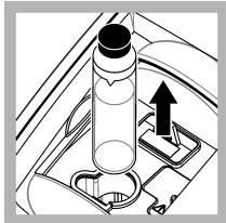
13. Odprite pokrov in odstranite vialo iz nosilca za vzorčno kiveto.
