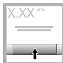
8. Pritisnite Očitaj. Prikazuje se vrijednost i status uspješno ili neuspješno. Podaci se automatski pohranjuju u instrumentu.
