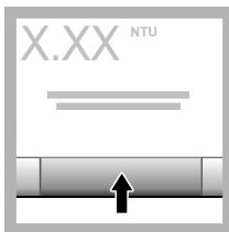
**15.** Si Verificar tras cal. está activada, se muestra el valor del estándar de verificación. Pulse **Medición** para medir el estándar de verificación.
