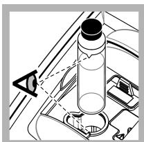
11. Поместите пробирку в держатель для кювет так, чтобы треугольник на пробирке совместился с отметкой на держателе для кювет. Чтобы закрыть крышку, нажмите на нее, пока не услышите щелчок.
