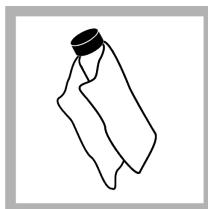
**7.** Gebruik de meegeleverde oiledoek om de olie gelijkmatig op het oppervlak van de monsterkuvetten aan te brengen. Verwijder de overtollige olie. Zorg dat de monsterkuvetten bijna droog zijn.
