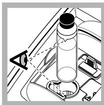
9. Placez la cuve dans le porte-cuve en alignant le triangle sur la cuve pour échantillon avec le repère de référence du porte-cuve. Appuyez sur le couvercle jusqu'à ce qu'un clic retentisse.
