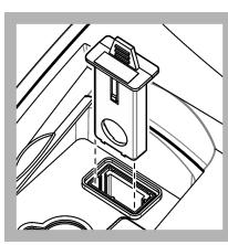
5. Držite jeziček sklopa filtrov USEPA tako, da so puščice usmerjene proti sprednjemu delu instrumenta. Pritisnite sklop filtrov do konca v ohišje.
