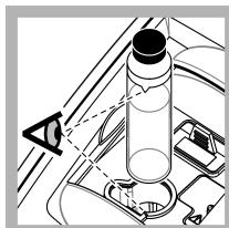
7. Setzen Sie die Ampulle so in den Küvettenschacht, dass das Dreieck an der Ampulle mit der Referenzmarkierung am Küvettenschacht übereinstimmt. Drücken Sie den Deckel nach unten, bis ein Klick zu hören ist.
