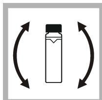
8. Inverta a célula de amostra, devagar e com cuidado, para misturar completamente a amostra. Tenha cuidado para não adicionar bolhas de ar.
