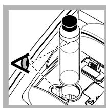
7. Поместите пробирку в держатель для кювет так, чтобы треугольник на пробирке совместился с отметкой на держателе для кювет. Чтобы закрыть крышку, нажмите на нее, пока не услышите щелчок.
