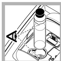
11. Placer reaktionsglasset i prøvekuvetteholderen med trekanten på reaktionsglasset justeret efter referencemærket på prøvekuvetteholderen. Tryk låget til, indtil der høres et klik.
