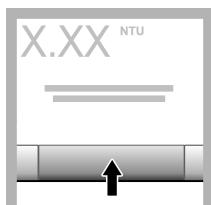
**15.** Αν είναι ενεργοποιημένη η επιλογή Επαλήθ. μετά βαθμ. εμφανίζεται η τιμή του προτύπου επαλήθευσης. Πατήστε Μέτρηση για να εκτελέσετε μέτρηση του προτύπου επαλήθευσης.
