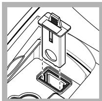
3. Αφαιρέστε τη διάταξη φίλτρου
