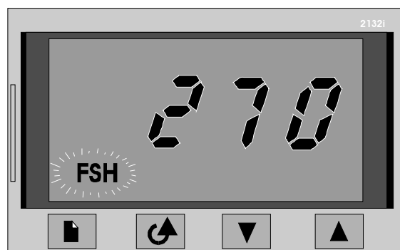
Fig. 27 : Le régulateur de sécurité de surchauffe 2132i (figure similaire)
