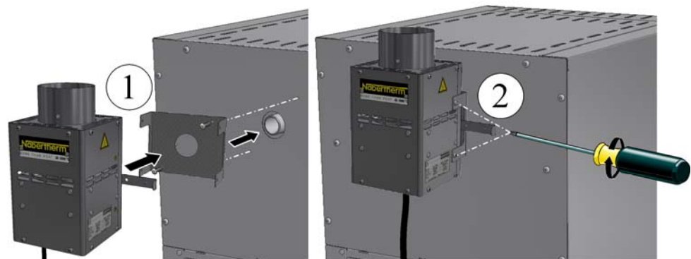
Fig. 18 : cheminée d'évacuation avec ventilateur
