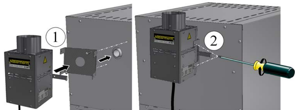
Fig. 18 : cheminée d'évacuation avec ventilateur
