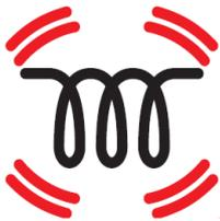
Témoin de chauffage : le voyant adjacent s'allume ou clignote pour indiquer que les éléments sont sous tension.
