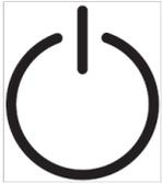
Interrupteur d'instrument : en l'actionnant, le circuit de régulation de la température est mis sous tension.
