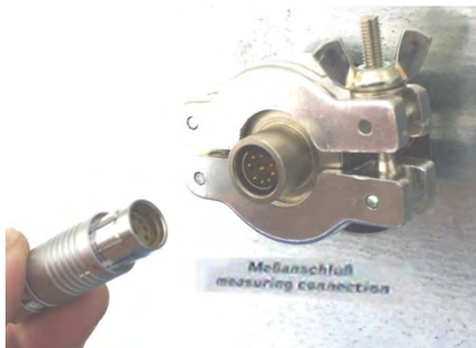
Figure 23: Connexion de mesure (12) avec passage de mesure
