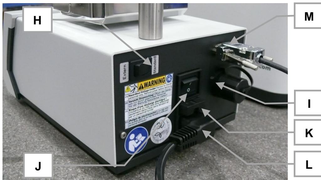
III. 4 : Dos de l'appareil – raccord de courant et interface
