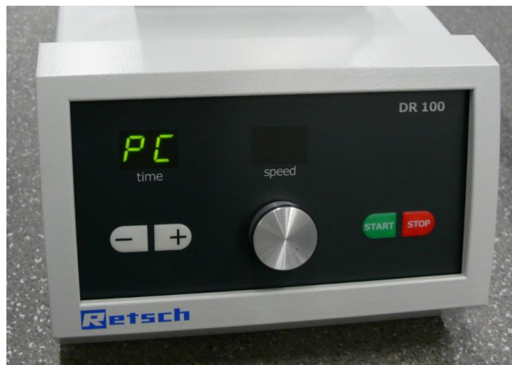
III. 30 : Écran de l'appareil d'alimentation lors de la commande via le ZM 300
