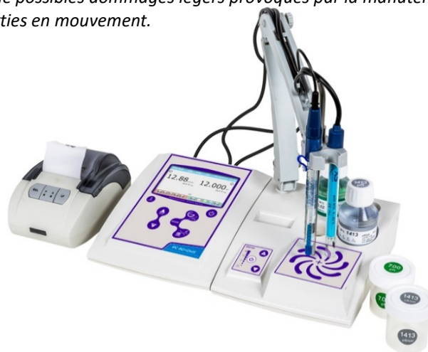
Exemple de multiparamètre en version avec AGITATEUR.
