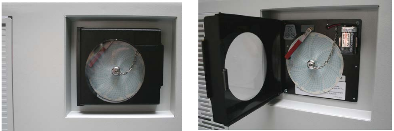
Figure 60: Enregistreur à bande de papier circulaire en bas à droite sur le front du congélateur
