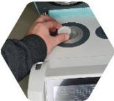
Etape 4 : Placer la coupelle en aluminium dans la chambre de mesure.
