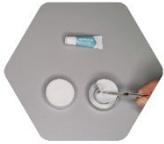
Etape 1 : Placer le disque papier dans la coupelle en aluminium (fournie dans le starter kit).
