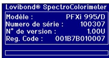
A l'allumage de l'instrument, l'écran affiche le numéro de modèle, le numéro de série et la version de micrologiciel installée.
