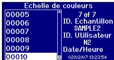
Appuyez sur **▲** ou **▼** pour déplacer la barre de mise en évidence de manière à sélectionner la mesure enregistrée. Les détails de la mesure sont indiqués sur le côté droit de l'écran.
