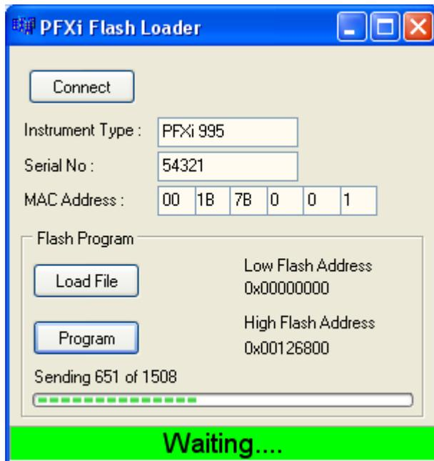
Une fois la programmation terminée, l'écran à cristaux liquides affiche 'Redémarrer l'instrument Mise à niveau réussie'. Eteindre alors l'instrument puis le redémarrer. Vérifier que la version logicielle est correcte sur la fenêtre d'attente de l'instrument (elle doit correspondre à la partie version du nom du fichier).
