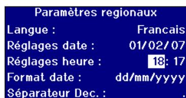
Appuyez sur **▲** ou **▼** pour placer la barre de mise en évidence sur **“Réglage de l'heure”**. Le premier élément mis en évidence correspond à l'heure. Les heures se présentent sous format d'horloge de 24 heures.
