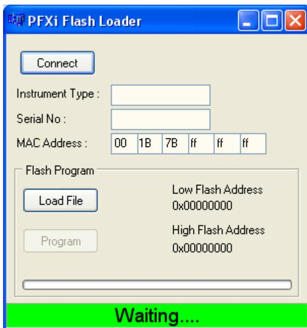
La barre d'état verte indique que le logiciel a établi une bonne communication avec l'instrument.
