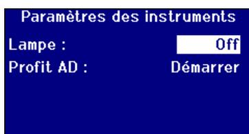
Appuyez sur **▲** ou **▼** pour placer la barre de mise en évidence sur **"Lampe"**. La lampe peut être allumée et éteinte pour la tester.
