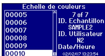
Appuyez sur **▲** ou **▼** pour déplacer la barre de mise en évidence de manière à sélectionner la mesure enregistrée. Les détails de la mesure sont indiqués sur le côté droit de l'écran.
