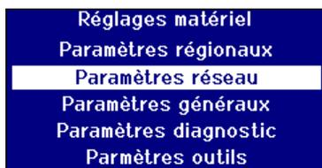
Appuyez sur **▲** ou **▼** pour placer la barre de mise en évidence sur **“Réglages de réseau”**.
