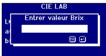
Si l'échelle colorimétrique ICUMSA a été sélectionnée et la valeur Brix a été fixée sur un réglage manuel, l'écran suivant apparaît.
