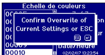
Si les réglages actuels de l'instrument sont différents de ceux de la mesure enregistrée, il est nécessaire de confirmer une modification des réglages correspondant à ceux de la mesure enregistrée.
