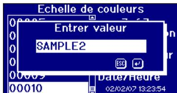
L'identificateur d'échantillon de la mesure est indiqué dans la case de modification.
