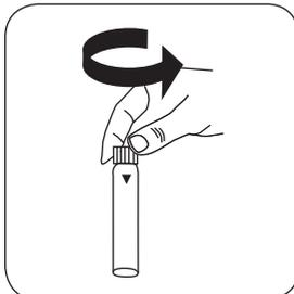
Ouvrez la **cuvette de réactif** .
