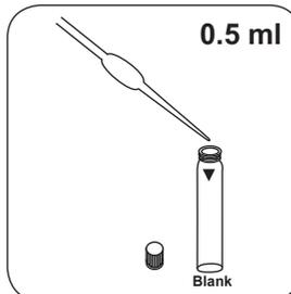
Versez **0.5 ml d'échantillon** dans la cuvette. Fermez la(les) cuvette(s).
