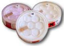
Nous recommandons de démarrer le calibrage au point 75 HR ; puis de passer au 84/90 % et ensuite au 58 %, 33 % et finalement au 11 %.
