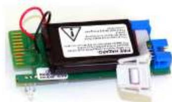
Le LabSwift-aw peut être équipé d'une batterie Ion-Lithium assurant jusqu'à 20 heures d'autonomie.
