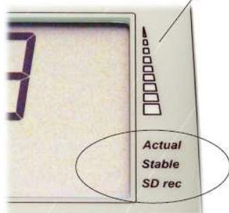
Le **LabSwift-aw** est alimenté par le secteur. Une batterie ion-Lithium peut-être proposée en option. La carte SD peut-être lue et les informations collectées via un PC sous forme de bloc note.
