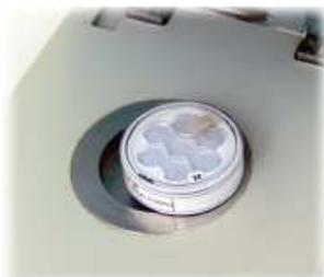
Chaque **LabSwift-aw** est calibré en usine et livré avec un certificat de calibrage aux points 0.11, 0.33, 0.58, 0.75 et 0.84.
