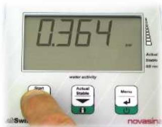
Mettre l'échantillon dans une coupelle. Assurez-vous que la coupelle est propre, que l'échantillon est bien disposé.
