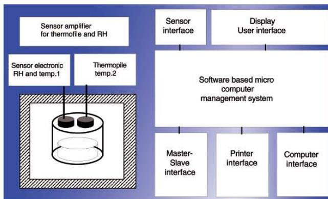
Le LabSwift-aw réunit la combinaison d'une cellule électrolytique résistive intégrée dans le capteur d'aw. Le signal de mesure est associé à une mesure de la température par IR (infrarouge).
