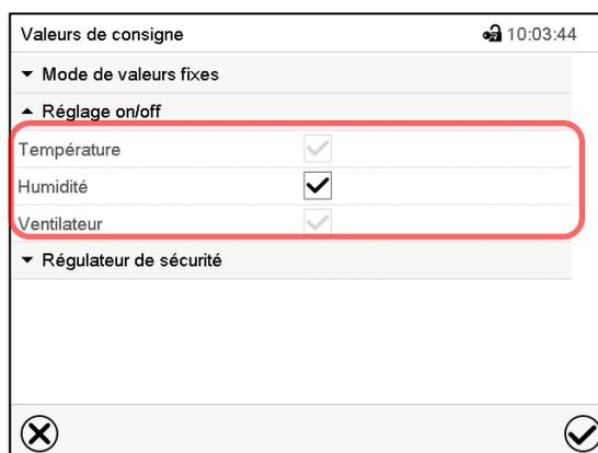
Vous pouvez activer ou désactiver la régulation d'humidité (humidification / déshumidification). Quand le boîtier de commande est marqué, la régulation d'humidité est active.
