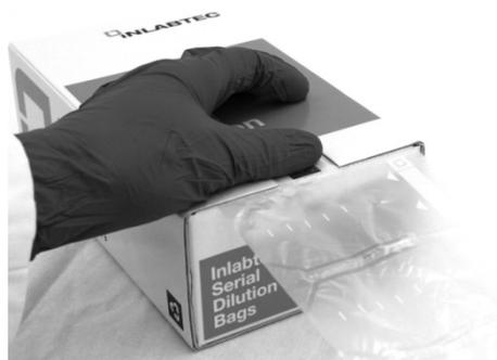
Appuyer avec deux doigts sur l'emballage sur les deux côtés de la fente d'ouverture. Les Bags se déchirent le long de la perforation. La déchirure fonctionne le mieux en tirant le Bag vers le bas, à partir de la fente au milieu des Bags.
