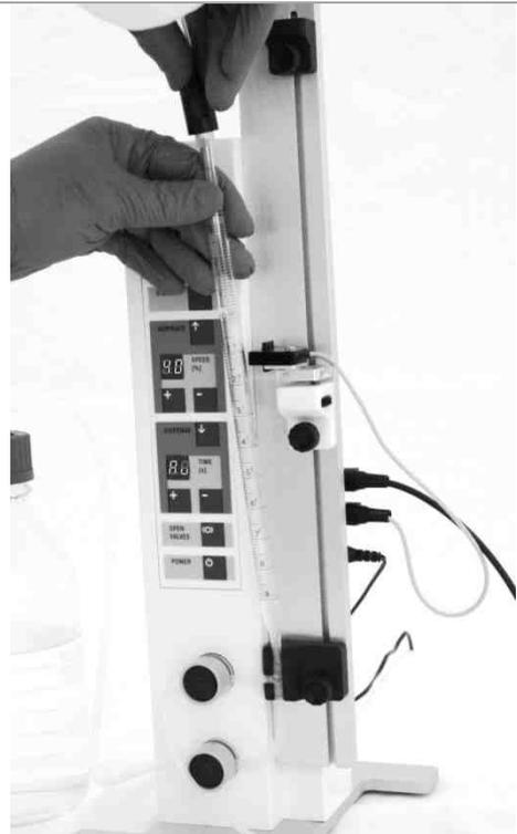
Déplacer le support supérieur de la pipette en dévissant la vis de serrage et l'amener à la hauteur de l'embout de la pipette et bloquer la pipette latéralement.
