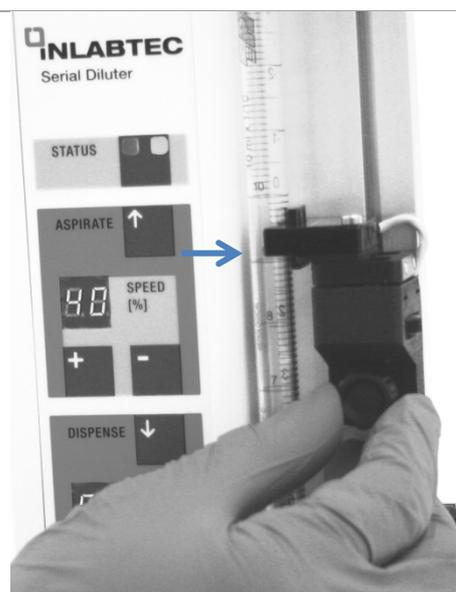
Si le volume aspiré diffère du volume désiré, ces niveaux peuvent être corrigés avec le réglage fin. En tournant l'écrou moleté vers l'avant cela augmente le niveau, en le tournant en arrière cela fera baisser le niveau de la pipette.
