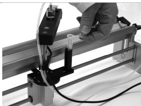
Le bras de dosage est basculé en arrière et la doseuse immergée dans 70% d'éthanol. Le manchon blanc de la doseuse ferme hermétiquement le tuyau de réaction et empêche l'évaporation de l'éthanol. Après 48 h la doseuse est toujours immergée dans l'éthanol.
