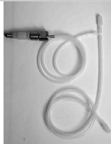
Les tuyaux avec la doseuse montée sont passés à l'autoclave dans une poche correspondante. La doseuse est enveloppée d'une feuille d'aluminium de sorte que lors de l'enlèvement et l'installation il ne peut pas y avoir une contamination accidentelle.
