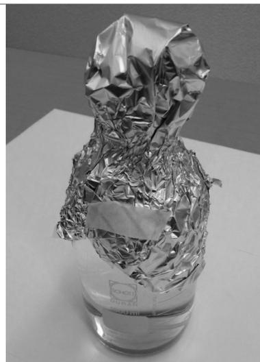
Après avoir sorti la bouteille de l'autoclave, visser le capuchon de connexion GL 45, ainsi qu'un échange de gaz avec l'intérieur de la bouteille peut avoir lieu qu'à travers le filtre stérile PTFE de 0,2  $\mu\text{m}$  et le contenu de la bouteille reste stérile.
