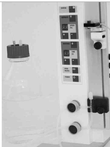
Raccorder le tuyau de la valve inférieure au diluant.
