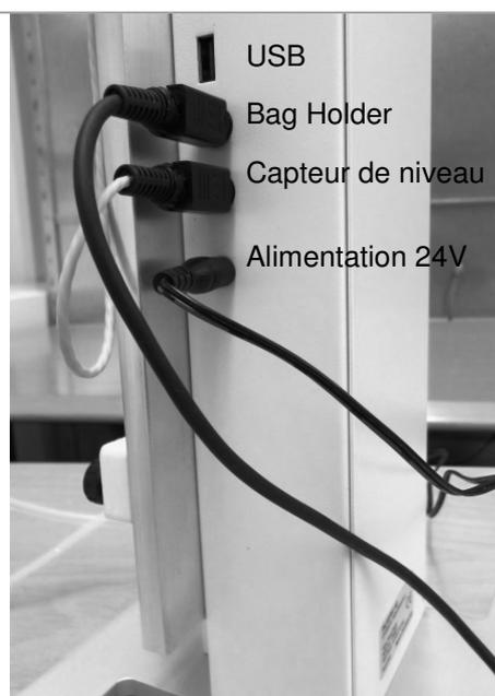
Veiller à ce que la tension du réseau électrique corresponde à la tension indiquée sur la plaque signalétique de l'alimentation 24V (100 – 240 VAC, 50 – 60 Hz) et doit être équipé avec les fusibles et dispositifs de sécurité électriques appropriés.
