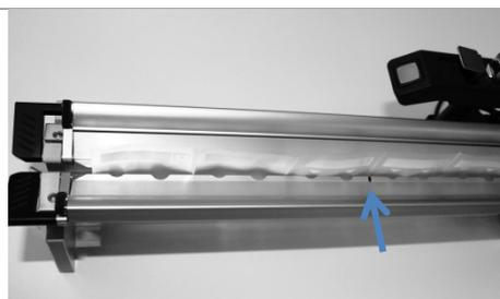
En fermant et ouvrant les supports des onglets avec les poignées latérales noir les sacs sont ouverts. Pour cela les onglets supérieurs des Bags sont ouverts et maintenus par des ventouses de préhension intégrées.
