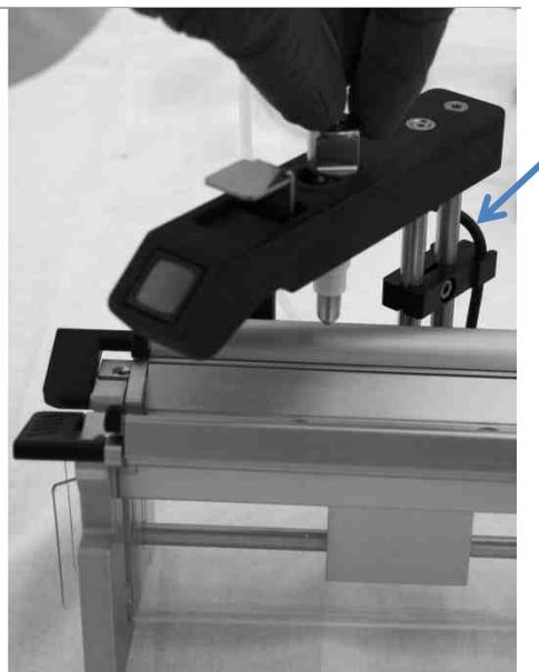
Insérer la pièce T des tubes dans le support de la pipette en dessous. Ne pas retirer le bouchon de silicone sur la pièce T.
