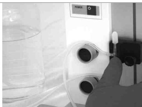
Appuyer sur le bouton POWER pour allumer le Serial Diluter et ensuite appuyer sur le bouton OPEN VALVES. Dans l'affichage inférieur des lignes horizontales apparaissent et les valves à manchon s'ouvrent. Les tubes de silicone peuvent être insérés.
