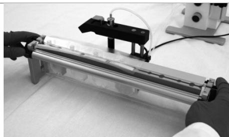
Pour reprendre et enlever les sacs facilement, les onglets détachés sont à plier avec le support des onglets des Bags légèrement vers le haut.
