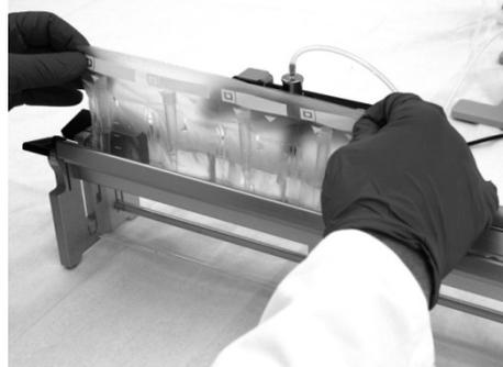
Maintenant les Bags peuvent être retirés du Bag Holder et transférés au stockage, entreposage ou pour l'élimination dans le Bag Shell.
