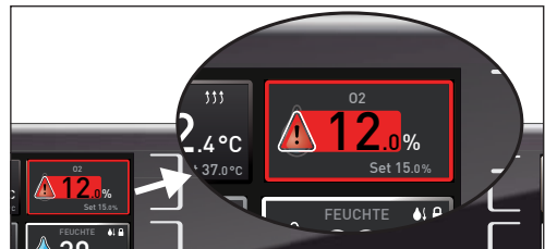
Ill. 23 Déclenchement du dispositif de sécurité de l'oxygène
