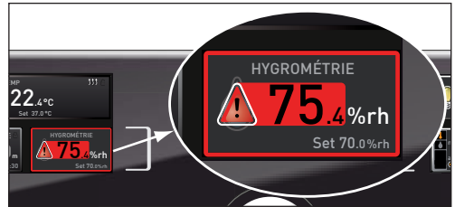
Ill. 21 Déclenchement du dispositif de sécurité hygrométrique
