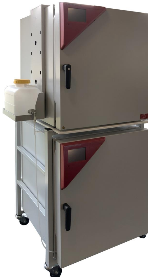
Figure 20: Deux incubateurs CB avec l'alimentation en eau par nourrice d'eau fraîche installée (option)
