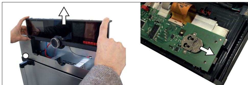
Ill. 32 Retirer la batterie lithium
