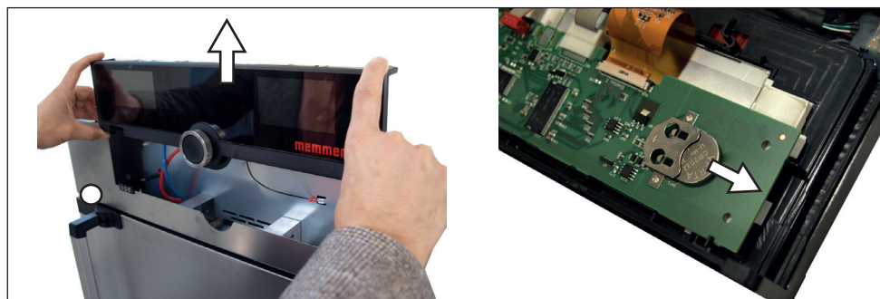
Ill. 23 Retirer la batterie lithium
