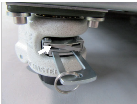
Ill. 12 Déplacer le culbuteur vers la gauche pour rentrer le pied
