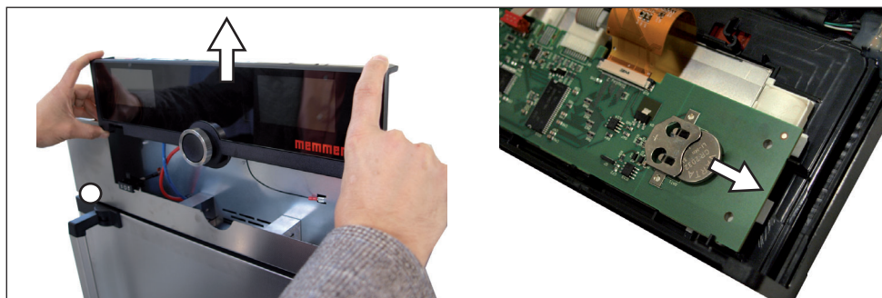
Ill. 29 Retirer la batterie lithium
