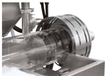
Bride avec insert de protection contre les irradiations de chaleur (installation d'alimentation en gaz 15)
