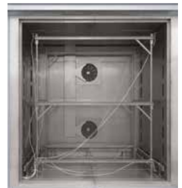
Cadre de cartographie adapté pour four chambre à circulation d'air N 7920/45 HAS
