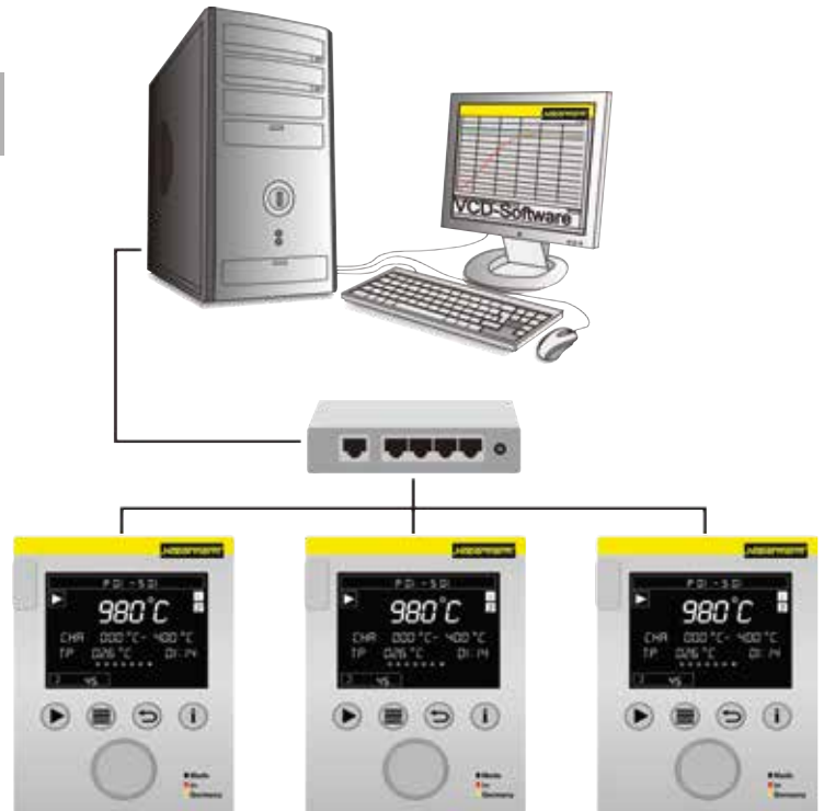
Exemple de montage avec 3 fours
