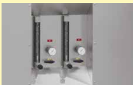
Système d'alimentation en gaz automatique
