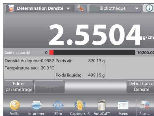
Une fois que les poids nécessaires ont été déterminés, la densité de l'échantillon est affichée en **g/cm3** (conjointement au poids dans l'air, et au poids dans l'eau) sur l'écran application.
