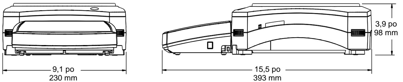
Figure 9-2 Modèles sans pare-vent
