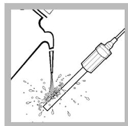
5. L'affichage met en évidence le tampon lu et affiche la valeur de pH corrigé en température. Rincer l'électrode à l'eau déminéralisée et avec le tampon suivant avant de la mettre dans la solution de tampon suivant.
