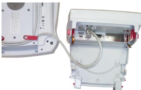
Câble du terminal
