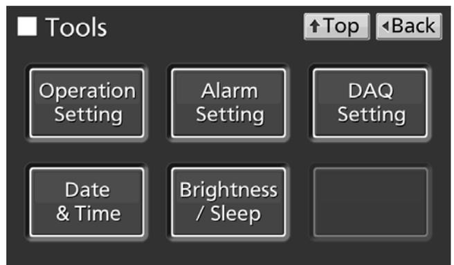
4. Seleccione los ajustes requeridos para el brillo y el modo de suspensión en la pantalla Brightness/Sleep (Brillo/Suspensión). Pulse la tecla Apply (Aplicar) para guardar los valores introducidos y ajustados. El display regresa a la pantalla Tools (Herramientas).
