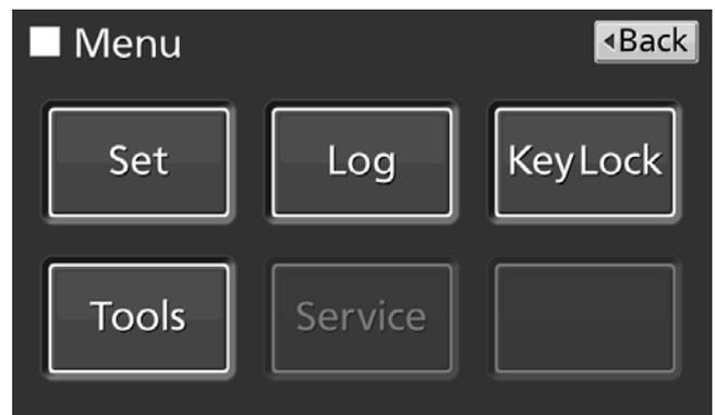
3. Introduzca cada parámetro. Pulse la tecla Apply (Aplicar) para guardar los valores introducidos. El display regresa a la pantalla de menú.
