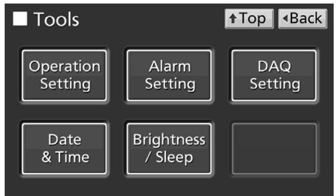
4. Introduzca la fecha y hora actuales en la pantalla Date & Time (Fecha y Hora). Pulse la tecla Apply (Aplicar) para guardar los valores introducidos. El display regresa a la pantalla Tools (Herramientas).
