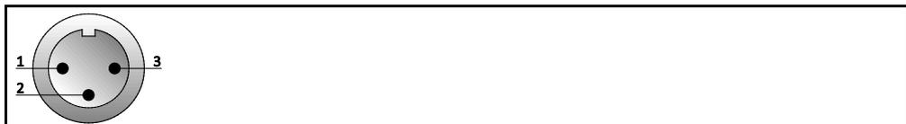
Le raccord se présente sous la forme de contact alternatif sec.
